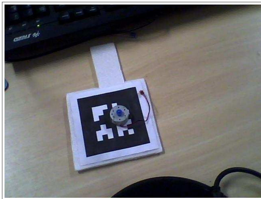
Figura 5.16: Motor Posicionado Sobre Marcador.
